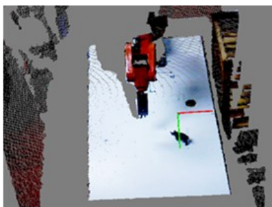
图3 三维重建SD700E实验环境的点云
